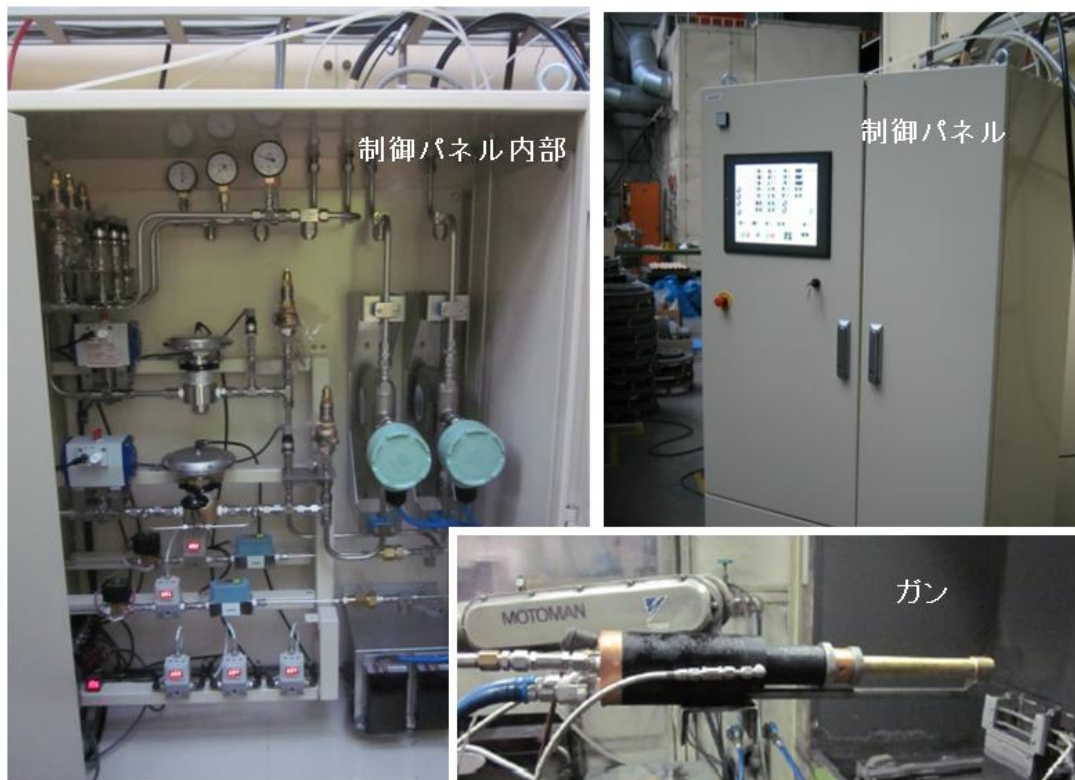
図 3 開発された高圧型ウォームスプレー装置の外観。制御パネル内には流量制御バルブ等が収納され PC 制御による自動化を実現、全自動で着火し所定の窒素ガス混合状態に到達・維持する機能を有する。
